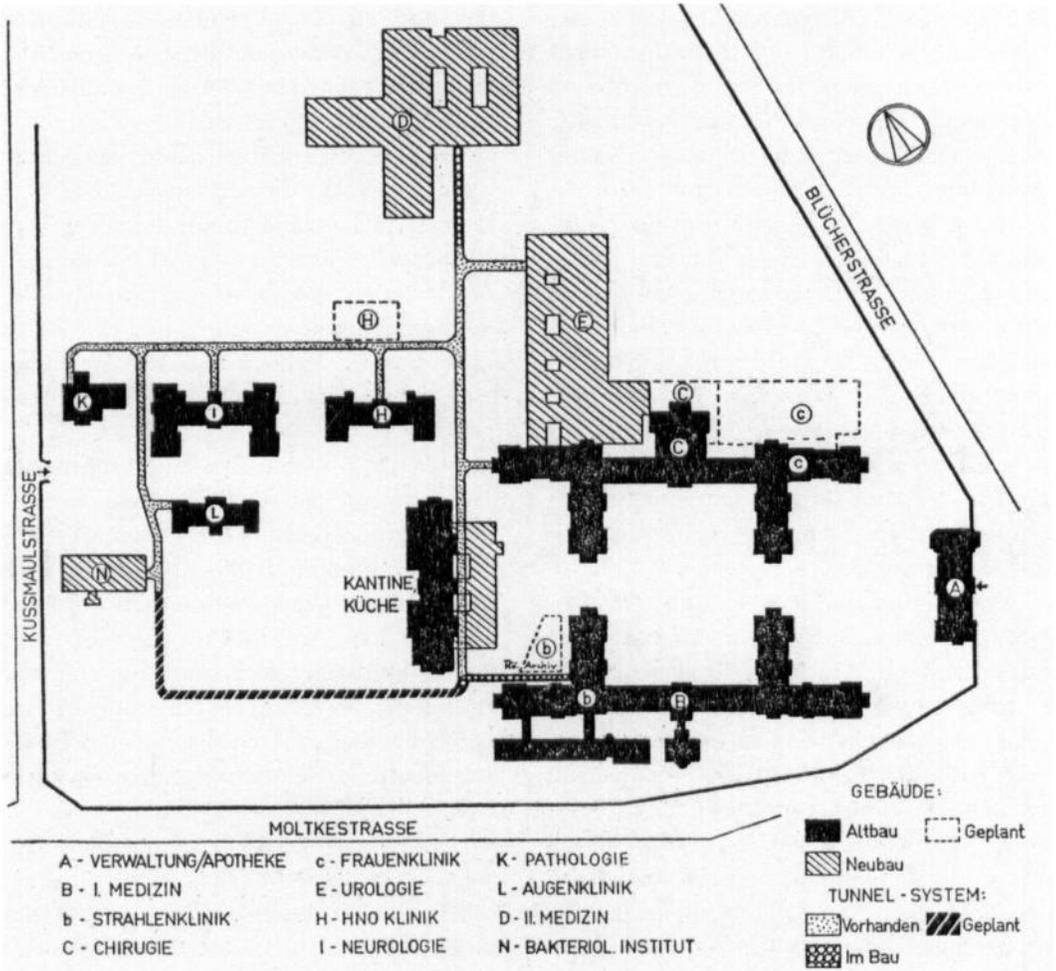
Ursprünglich war das unterirdische Tunnelsystem für Transporte sowie Ver- und Entsorgungsleitungen als Ring gedacht, der südliche Teil (Verbindung N – B-Bau) wurde nicht verwirklicht, weil er sich als überflüssig herausstellte, Skizze von 1970.
